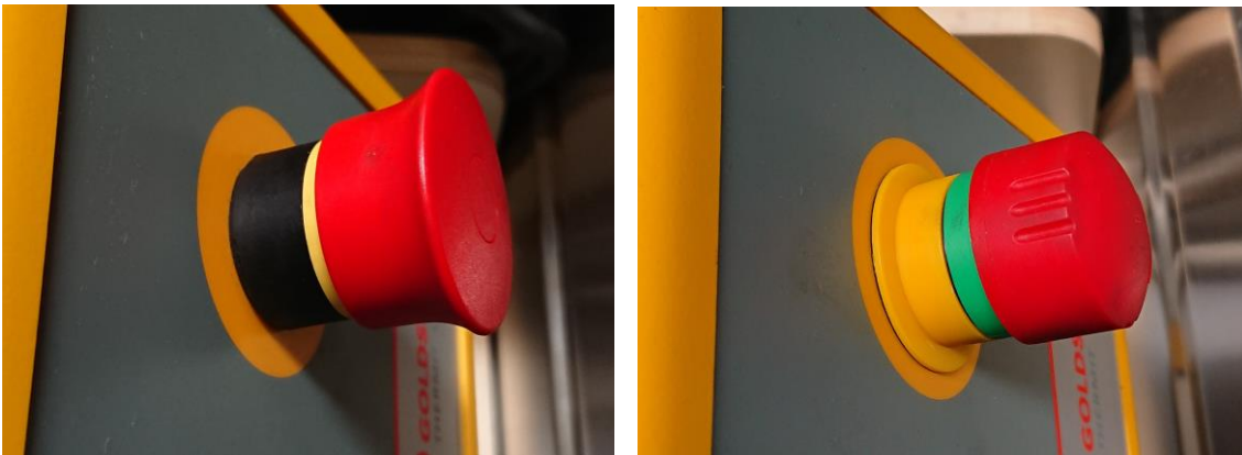
Obrázek 3: Obrázek vlevo: Spínač nouzového vypnutí, provedení 230 V; Obrázek vpravo: Spínač nouzového vypnutí-provedení 110 V
