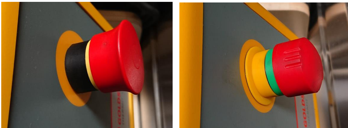
Abbildung 3: Bild links: Not-Aus-Schalter, Ausführung 230 V; Bild rechts: Not-Aus-Schalter, Ausführung 110 V
