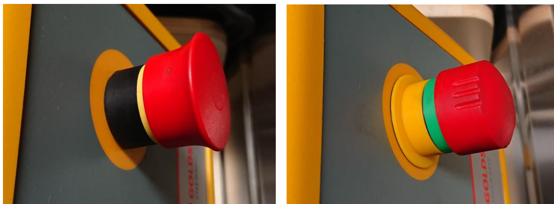
Illustration 3: Billede til venstre: nødstopafbryder, udførelse 230 V, billede til højre: nødstopafbryder, udførelse 110 V
