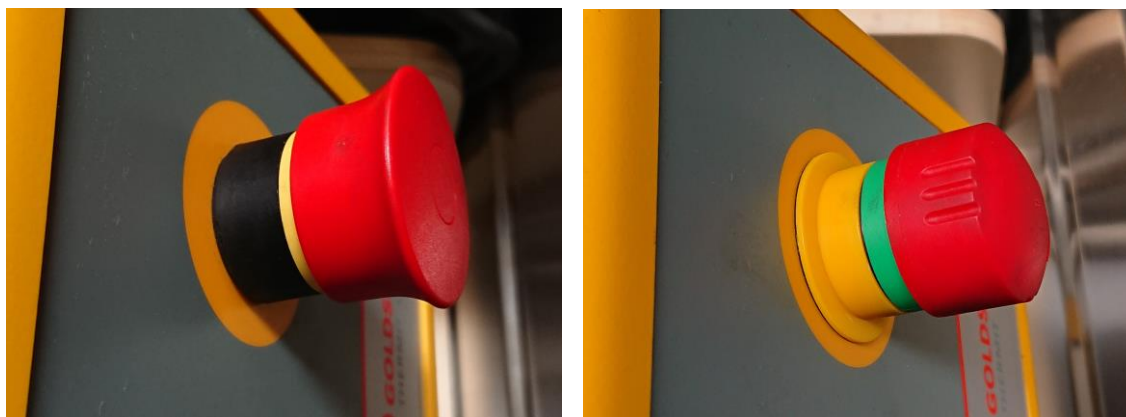
Figure 3 : Figure de gauche : Bouton d'arrêt d'urgence, version 230 V ; figure de droite : Bouton d'arrêt d'urgence, version 110 V
