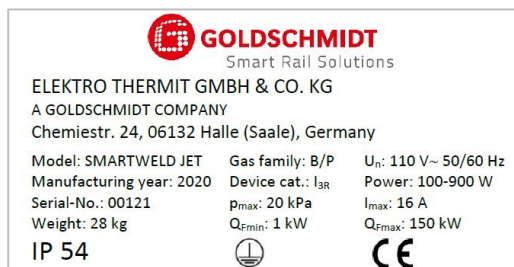
Рис. 1b. Пример заводской таблички Smartweld Jet, 110 В
