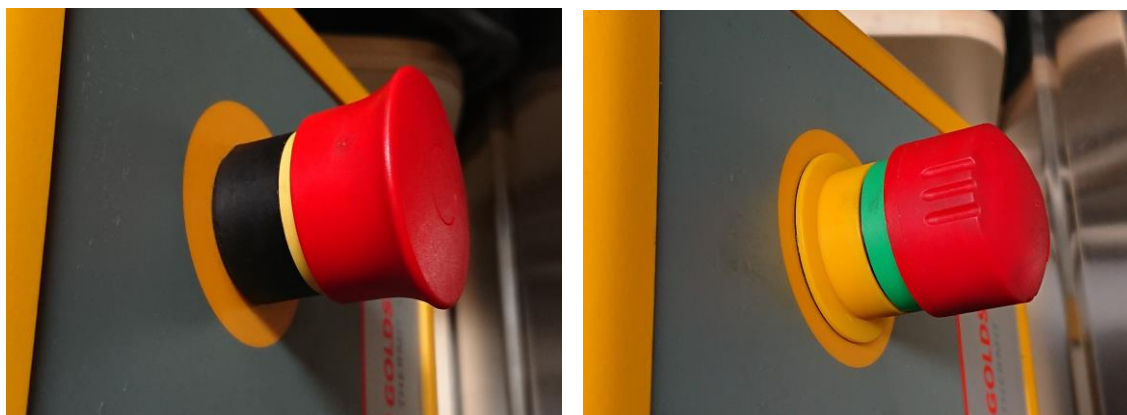
Рис. 3. Изображение слева: аварийный выключатель, исполнение на 230 В; изображение справа: аварийный выключатель, исполнение на 110 В
