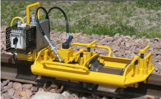
Skinnetrimeenhed, bestående af skinnetrimmer U-L 4 og drivaggregat type L
