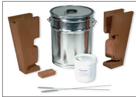
Abb. 4: Verbrauchstoffe (auszugsweise) für das Thermit-Schweißen mit SkV-Elite: Formen, Riegel, Einwegtiegel (Euro-Tiegel I), Abdichtpaste und Anzündstäbchen
