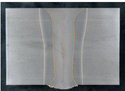
Abb. 7: Form der Auflösungszone und der WEZ, dargestellt im Längsschnitt am Beispiel einer SkV-Elite Schweißnaht am Schienenprofil 60E1
