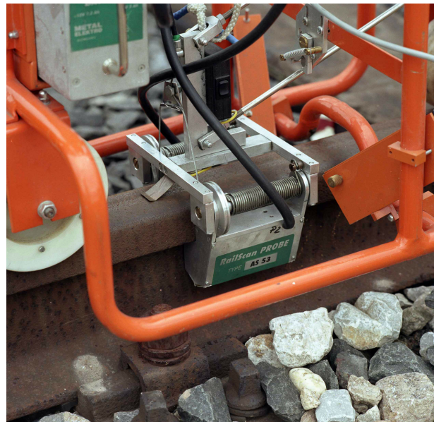
Abb. 2: RailScan Prüfkopf, nach Positionierung des Gerätes an Schienenkopf angekoppelt. Die Qualität der Ankopplung wird durch Kontrollparameter sichergestellt und im Messgerät dokumentiert
