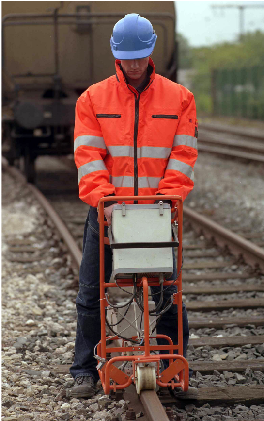
Abb. 1: Messgerät RailScan im Einsatz
