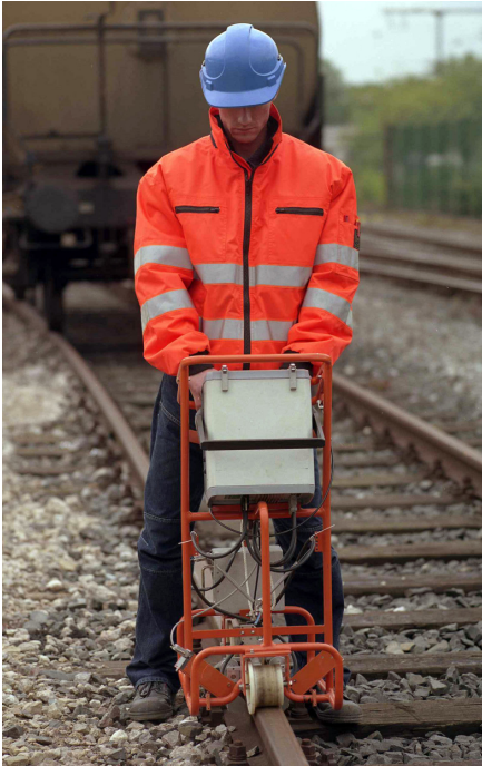
Abb. 1: Messgerät RailScan im Einsatz
